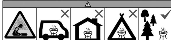
Ne pas faire fonctionner dans des locaux fermés et/ou habitables, par exemple des bâtiments, tentes, caravanes, mobile-homes ou bateaux. Danger de mort par empoisonnement au monoxyde de carbone.
