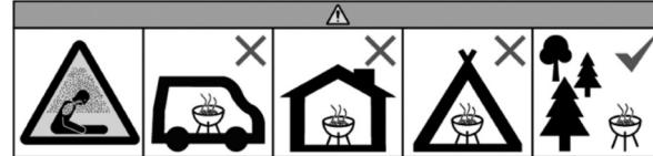
Non utilizzare in locali chiusi e/o abitabili, ad es. edifici, tende, roulotte, camper, barche. Esiste il pericolo di morte a causa di un'intossicazione da monossido di carbonio.
