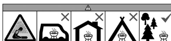
Ne üzemeltesse zárt és / vagy lakható helyiségekben, pl. épületben, sátorban, lakókocsiban, mobilházban, hajón. Itt életveszély áll fenn szénmonoxid mérgezés miatt.
