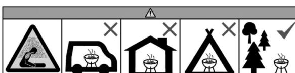
Non utilizzare in locali chiusi e/o abitabili, ad es. edifici, tende, roulotte, camper, barche. Esiste il pericolo di morte a causa di un'intossicazione da monossido di carbonio.
