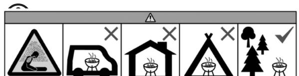
Ne pas faire fonctionner dans des locaux fermés et/ou habitables, par exemple des bâtiments, tentes, caravanes, mobile-homes ou bateaux. Danger de mort par empoisonnement au monoxyde de carbone.
