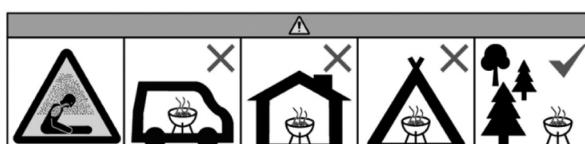
Η λειτουργία δεν επιτρέπεται σε κλειστούς ή/και κατοικήσιμους χώρους, π.χ. κτίρια, σκηνές, τροχόσπιτα, αυτοκινούμενα, σκάφη. Υπάρχει κίνδυνος θανάτου λόγω δηλητηρίασης από μονοξείδιο του άνθρακα.
